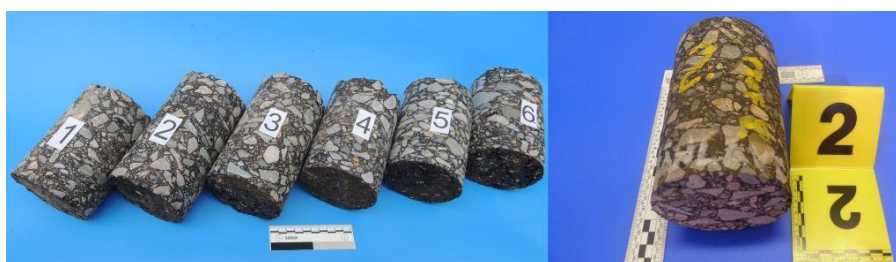
Obr. 5 – Válcová zkušební tělesa z R-materiálu pro laboratorní zkoušku pevnosti v prostém tlaku
