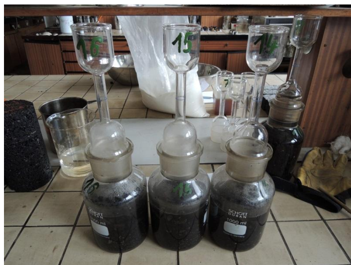
Obr. 8 – Pohled na laboratorní zkoušku stanovení maximální objemové hmotnosti asfaltové směsi v silniční laboratoři Fakulty stavební ČVUT v Praze
