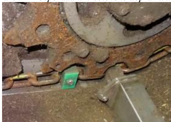
Obrázek 8 – Detail řetězu a hřebela
