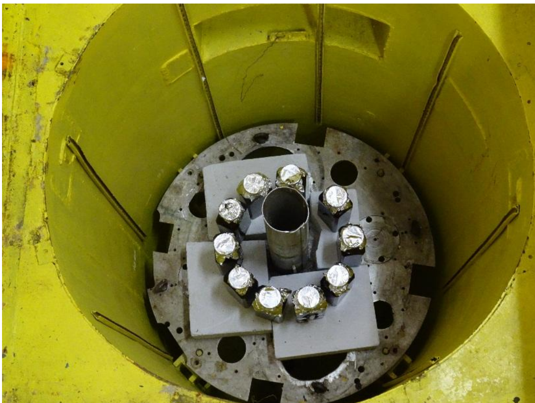
Obrázek 1: Pohled do ozařovacího zařízení v otevřené poloze (zdroj je umístěn ve stínění)
