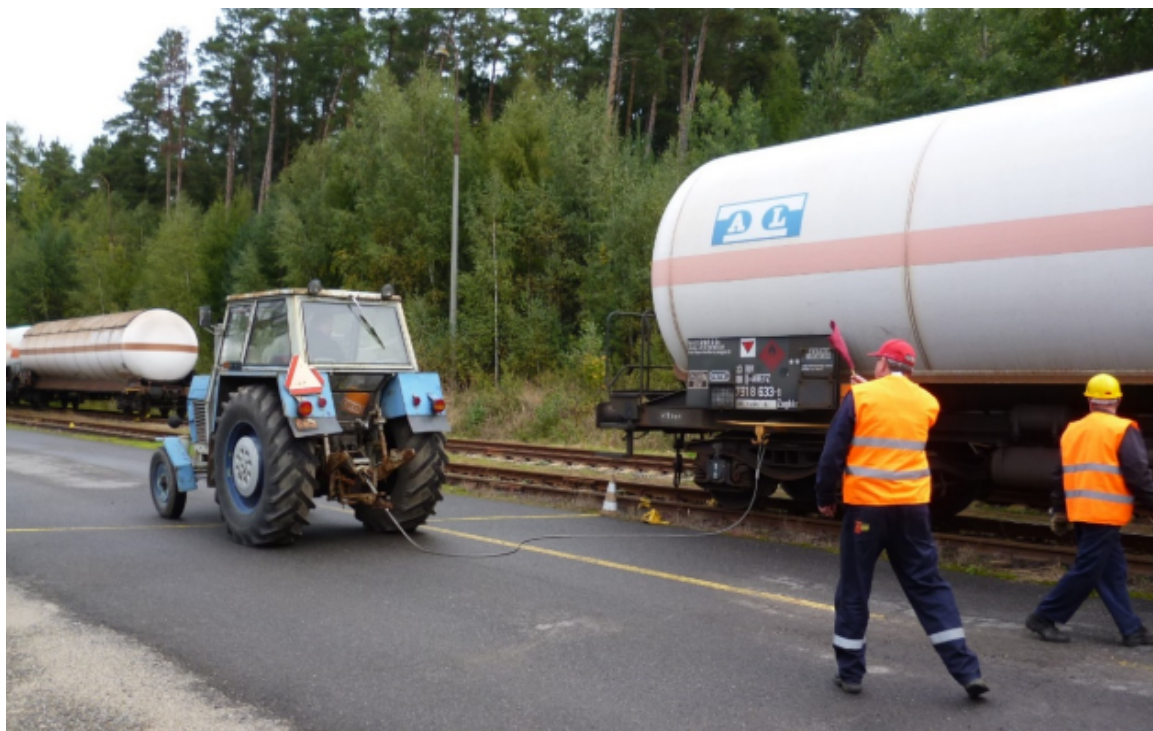
Obr 8 – Napojení kolového traktoru na železniční cisternu
