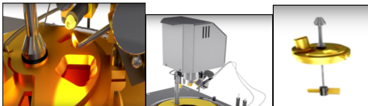
Obr. 1 Sestava zkušební kelímku a víčka: a) zkušební kelímek s víčkem, uzavírací clonou a zapalovacím zařízením (plamen, žhavený drátek), b) motor míchadla s nasadou hřídele míchadla, c) míchadlo se dvěma kovovými dvoulistými vrtulemi zabudované do středu víčka.
