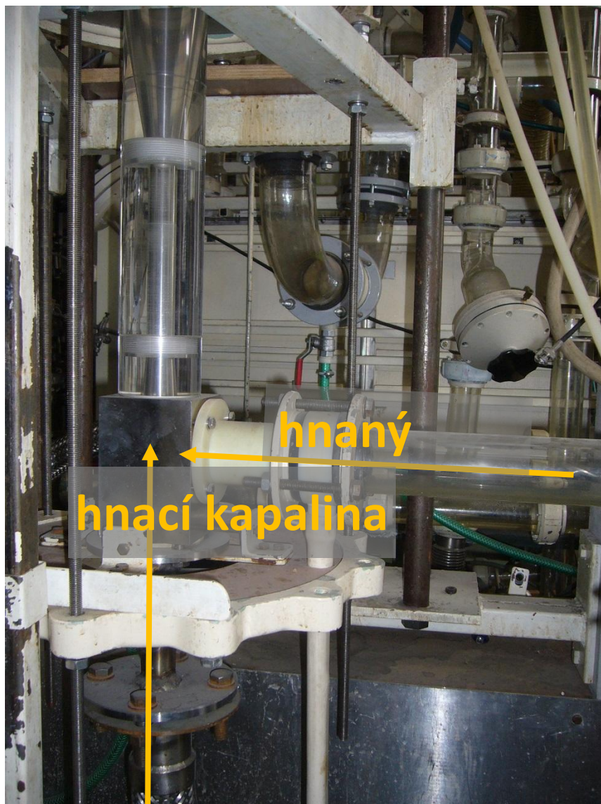
Obrázek 2: Detail poloprovozního ejektoru s vyznačením směru toku hnací a hnané tekutiny
