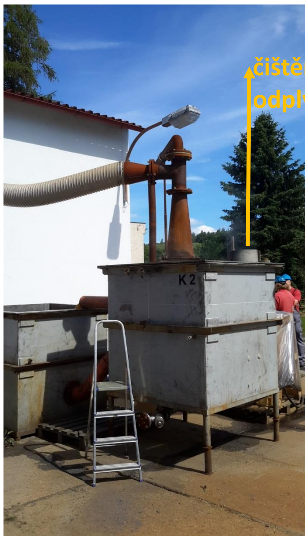
Obrázek 9: Výstup odplynu po průchodu provizorní ejektorovou jednotkou, kde byl zachycen dým tvořený jemnými pevnými částicemi.
