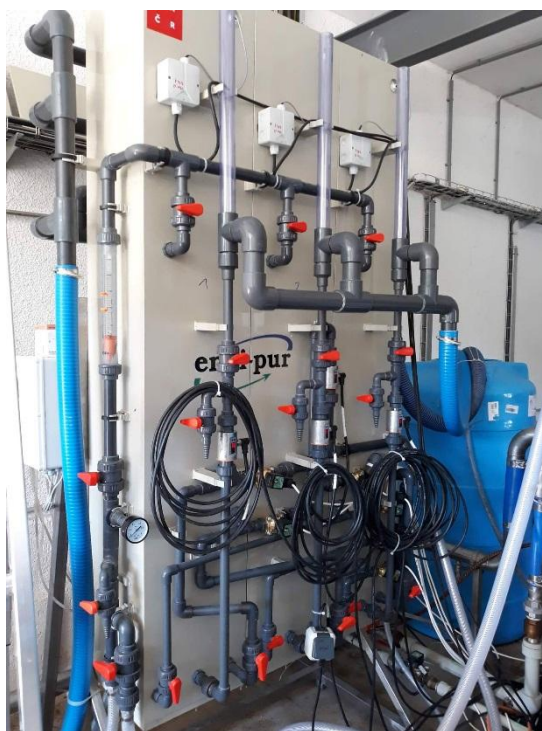
Obr.2: Poloprovozní zařízení pro testování adsorpce na GAU (ČOV Tuchoměřice)
