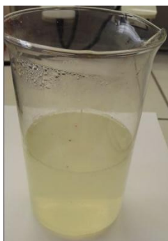
Obr. 7: Odpadní voda po reakci oxidu manganického s kyselinou šťavelovou
