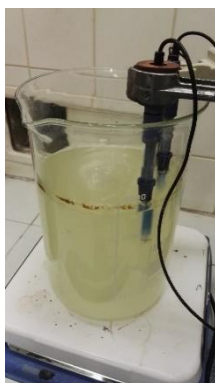
Obr. 12: Vzorek reálné odpadní vody po reakci s 0,1M KMnO_4 a odstranění MnO_2
