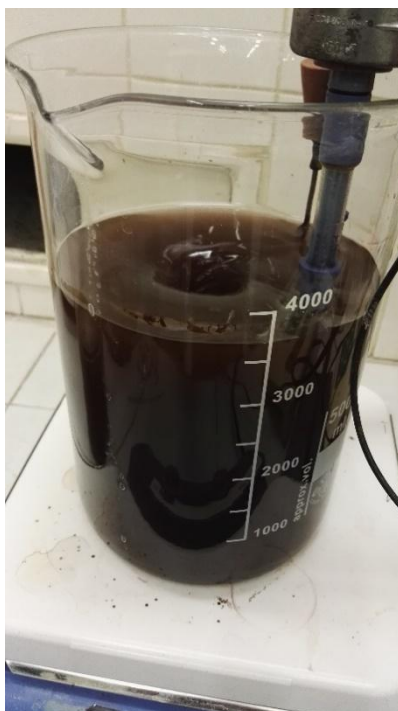
Obr. 11: Likvidace antibiotika v reálné odpadní vodě ve firmě Tekro spol. s r.o.
