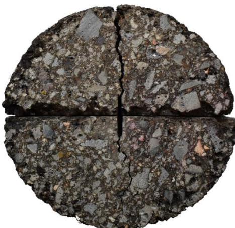
Obrázek 7: Půlválcová tělesa ze 100 % struskového kameniva po zkoušce odolnosti vůči šíření trhliny
