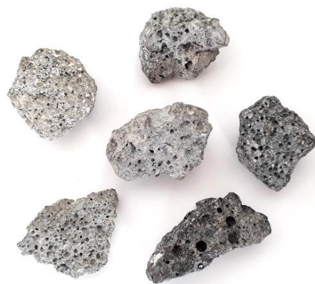
Obrázek 1: Struskové kamenivo s viditelnou pórovitou strukturou
