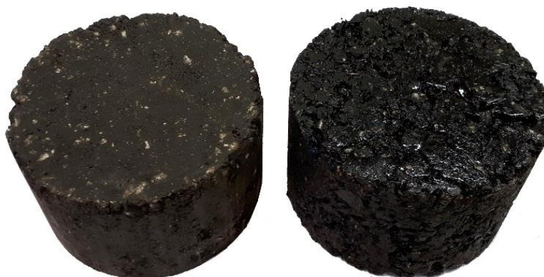
Obrázek 3: Vizuální porovnání asfaltové směsi se 100 % struskového kameniva (vlevo) a ref. směsi (vpravo)
