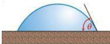
Obr. 8 Definice smáčecího úhlu vody.
