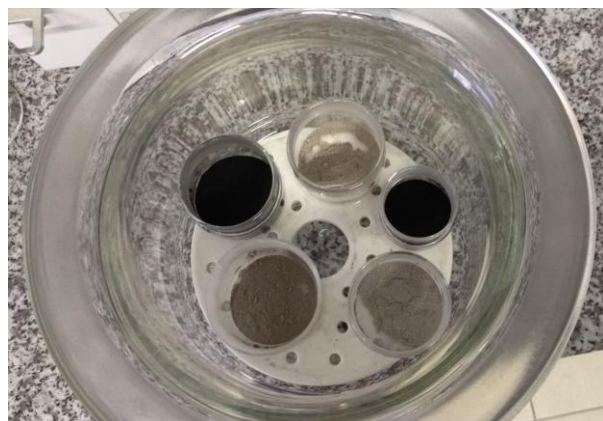
Obr. 2 Umístění vzorků do exsikátoru (vlevo), exsikátory umístěné v temperovaném boxu (vpravo)
