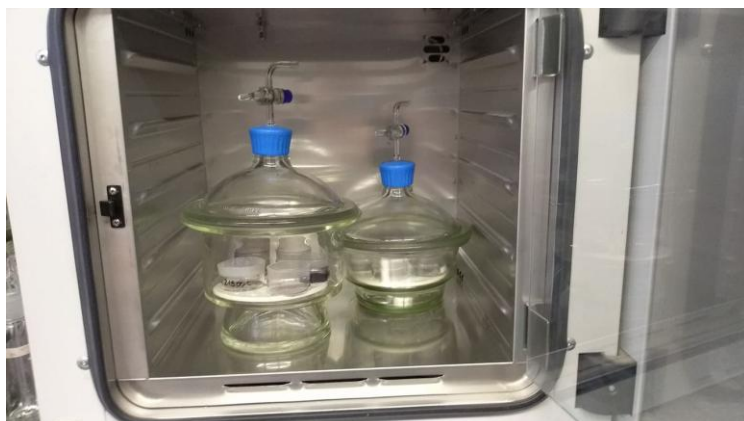
Obr. 2 Umístění vzorků do exsikátoru (vlevo), exsikátory umístěné v temperovaném boxu (vpravo)
