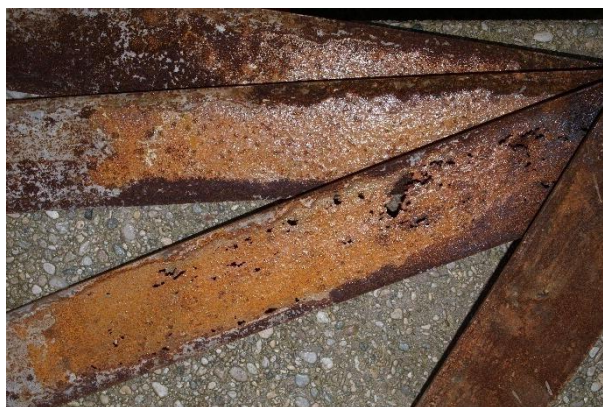
Obr. 3 Zcela upotřebené Fe deskové elektrody, které byly vyměňovány.
