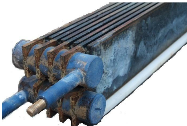
Obr. 2 Detail elektrodové kazety.
