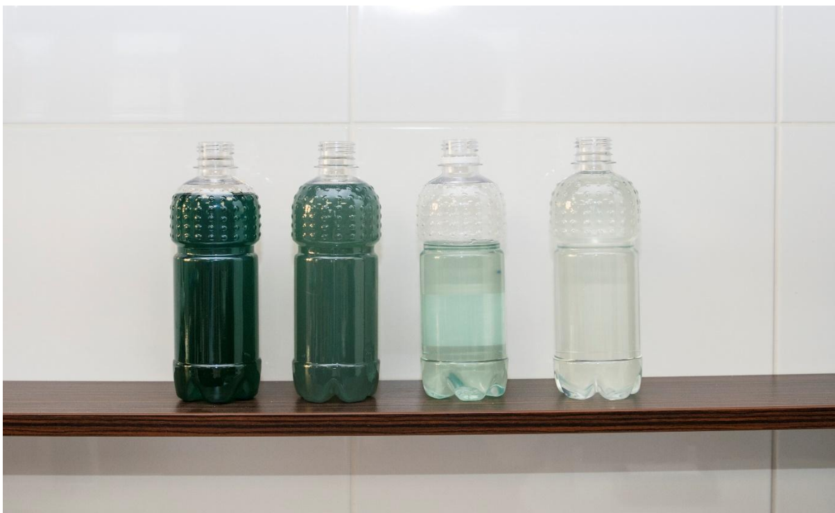
Obr. 2: Pomocí výzk. dotace se podařilo dosáhnout úplně čirého recyklátu (vlevo odpad).
