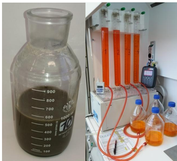
Obrázek 3 Anaerobní reaktor 1 dm 3 a celé zařízení pro BMP testy
