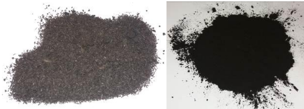
Obrázek 2 Biouhel (300 °C) v původním stavu (vlevo) a mletý práškový vzorek (vpravo)
