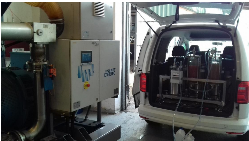
Obrázek 3 Čištění syntézního plynu na bioelektrárně na Slovensku
