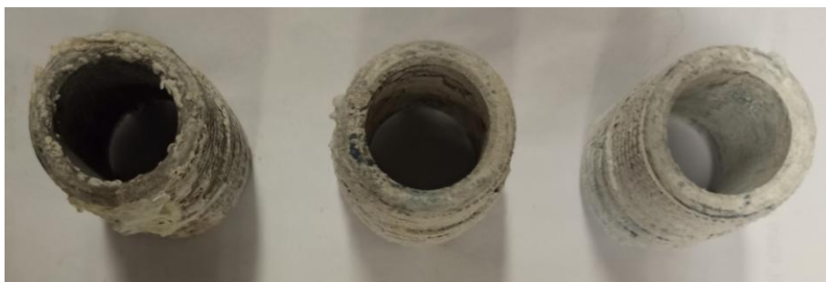
Obr. 3. Bílé hydrolyzní produkty na pozinkovaných záliscích po ukončení experimentu.
