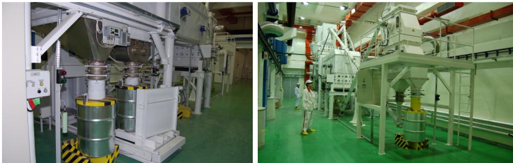
Obr.7 Pracovisko spracovania použitých VZT filtrov
