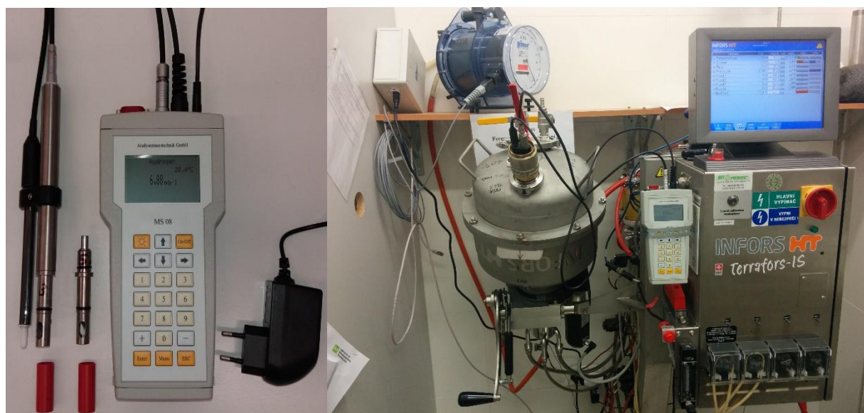
Obr. 5 Amperometrický mikrosenzor AMT MS 08
