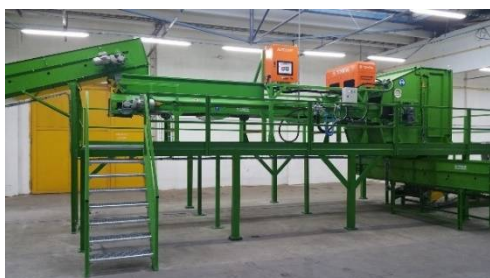
Obr.1 Spracovávaný plastový odpad a optická forma triedenia
