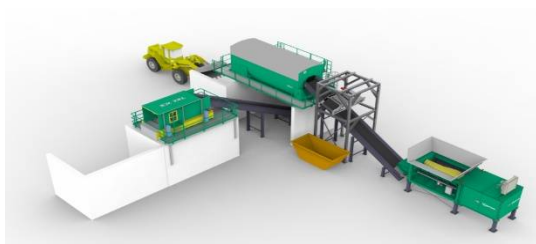
Obr. 5 a 6 : Jednoduchá mechanická triediaca linka na ZKO a výstupy zo spracovania
