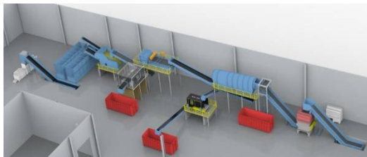
Obr.7 a 8 : Komplexnejšia mechanická triediaca linka na ZKO a výstupy zo spracovania
