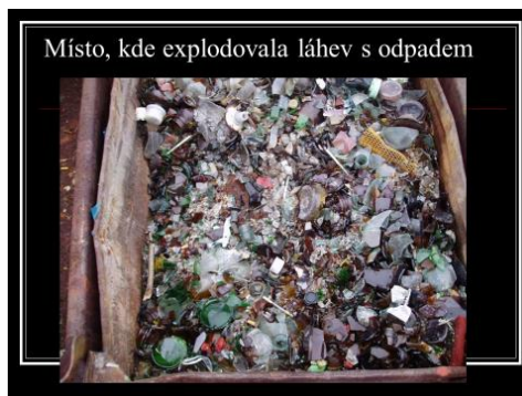
Obr. 4: Situace po výbuchu peroxidových zbytků. K explozi došlo při rozbíjení lahví. Foto autor.
