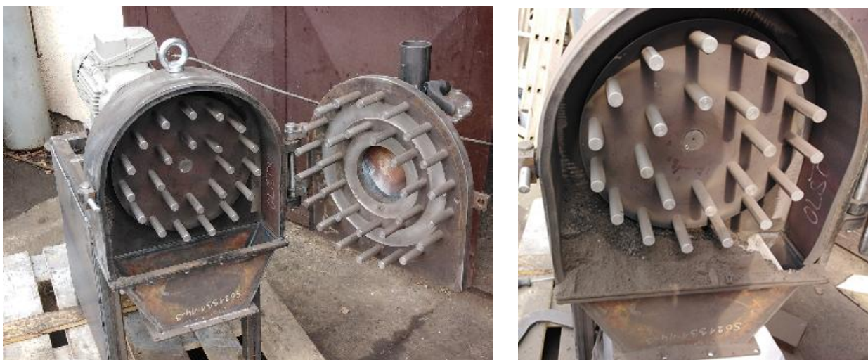
Obr. 4 : Zařízení pro jemné mletí teplárenské strusky (vlevo), detail mlecí komory s mletou struskou (vpravo)
