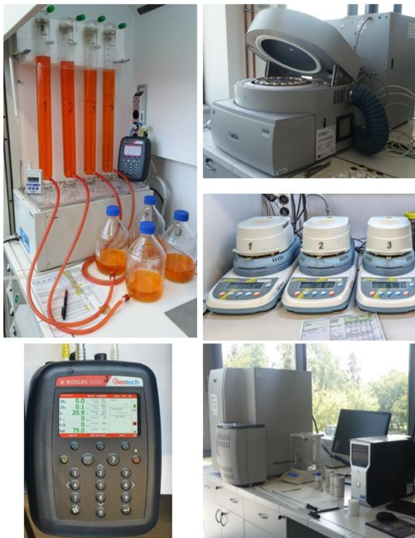
Obrázek 3 Aparatura pro BMP test, analyzátory bioplynu, TS, VS a CHNS
