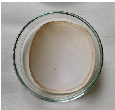
Obr. 4 Ultrafiltrační membránový filtr po experimentech s roztokem obsahujícím Fe^{3+}
