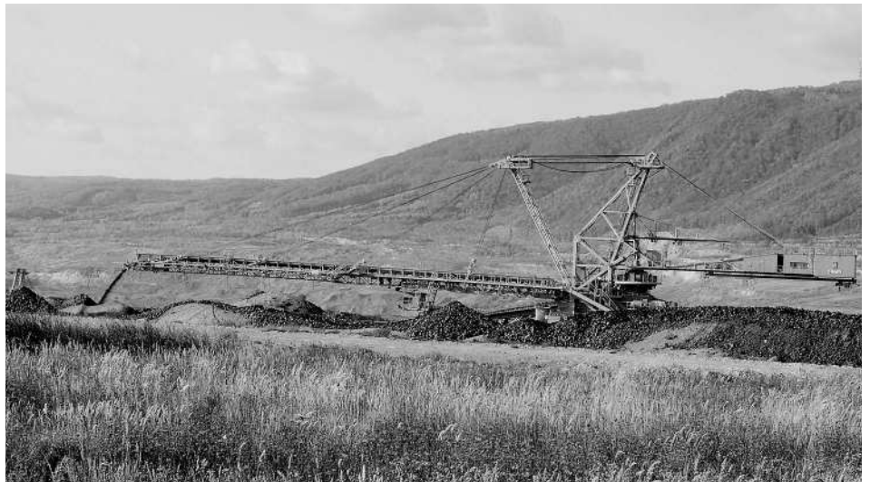
Zakládání výsypkových zemín
