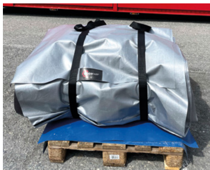
Skládací kontejner na dohašování elektromobilů v přepravním tvaru
