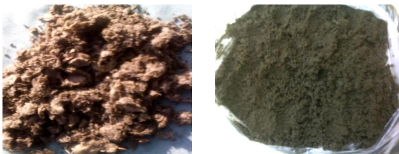
Obr. 3: Odpad z výroby skelné minerální izolační vlny z pod rozvlákňovacího stroje
