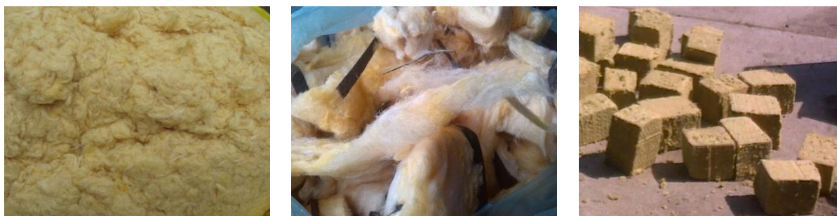
Obr. 4: Příklad odpadu z výroby minerální izolační vlny vzniklé za vytvrzovací komorou
