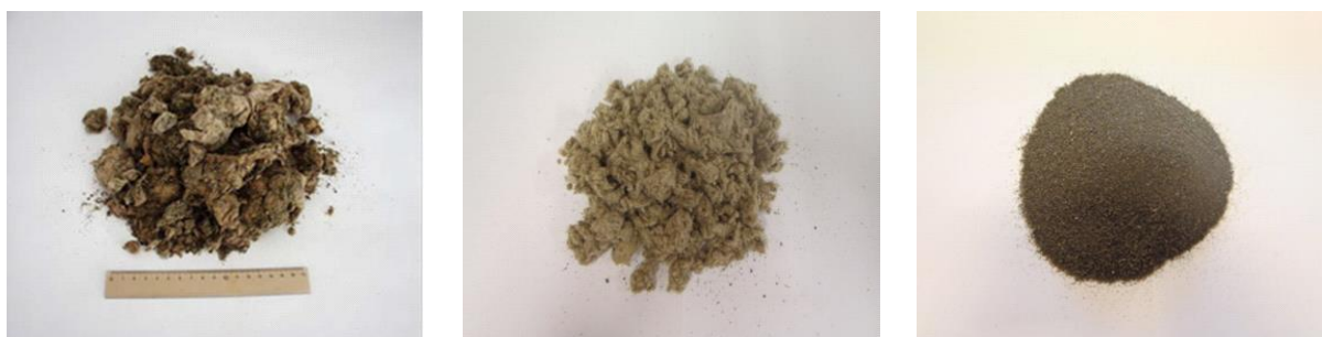
Obr. 6: Úprava směsného odpadu minerální vlny (vlevo) na minerální vlákno a granálie
