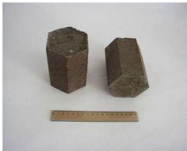
Obr. 1: Zpětný produkt vracející se do tavící lázně - brikety
