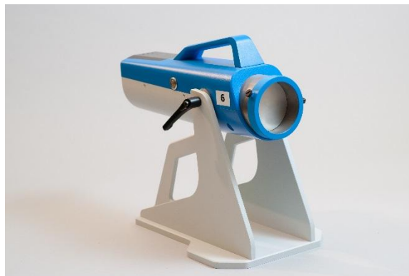
Obrázek 2 Přístroj na měření J 131 s wolframovým kolimátorem pro větší děti a dospělé
