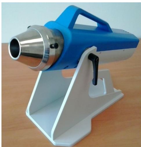
Obrázek 3 Přístroj na měření J 131 s Pb kolimátorem pro měření nejmenších dětí
