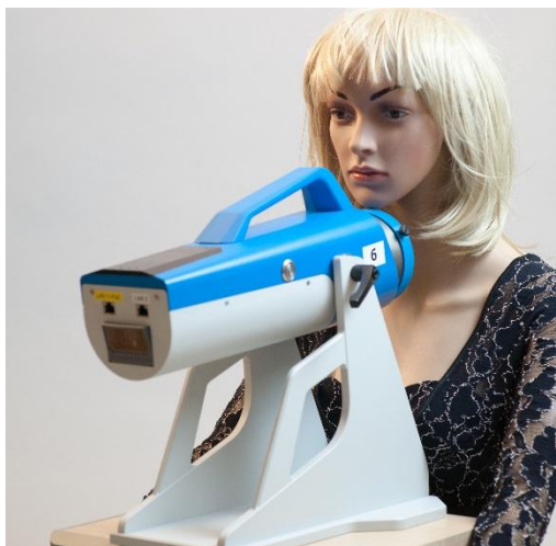
Obrázek 1 Geometrie měření J 131 ve štítné žláze
