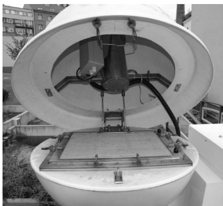
Obrázek 26 JL-900 (Senya) pohled na měřicí sondu nad filtrem
