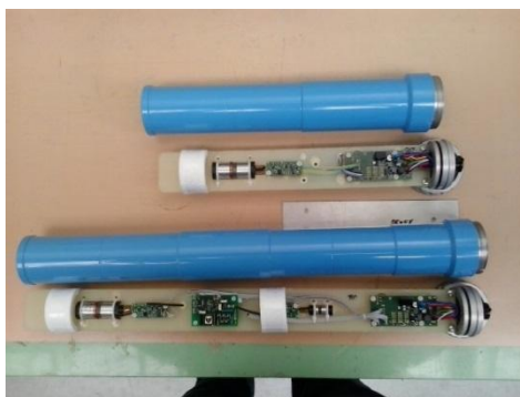
Obrázek 16 Elektronika sond s Geiger detektory
