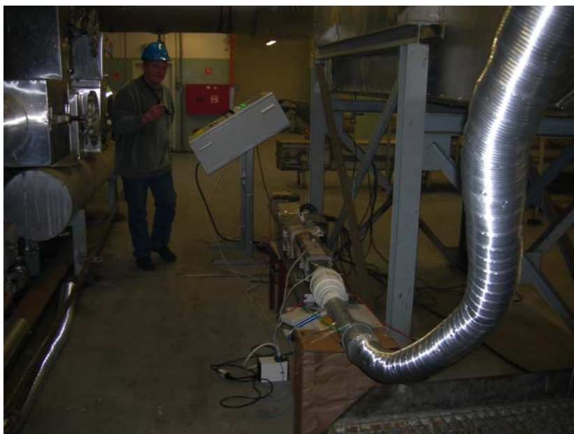
Obr. 15: Použití MSJ při testování eliminace pachů v lisovně olejů
