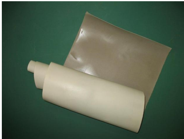
Obr. 2: Bipolární membrána BM3.0
