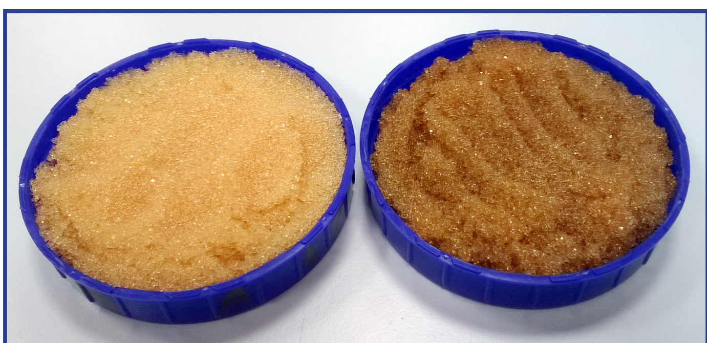
Vlhké ionexy před sušením. Vlevo anex A-400 (světlý), vpravo katex C-100.
