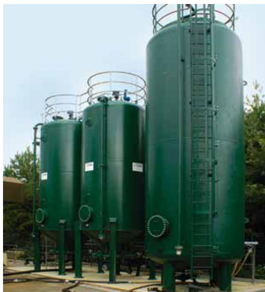
Příklad aplikace adsorpčních kolon firmy Donau Carbon plněných granulovaným aktivním uhlím získávaným pyrolýzou kokosových skořápek
