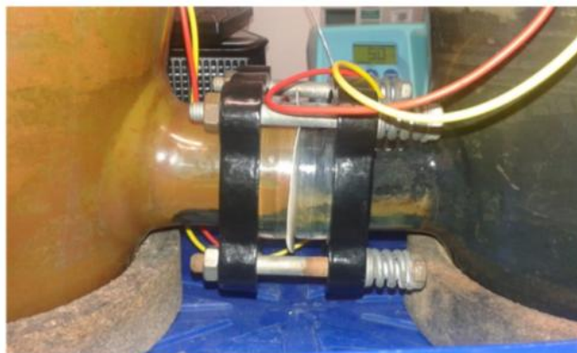
Obr. 5: Fotografie dokumentující průběh reaktorových testů. Vlevo napojení reaktorů na plynový chromatograf, vpravo detail spojení katodového reaktoru (černá barva) a anodového reaktoru (rezavě hnědá barva) iontovýměnnou membránou.
