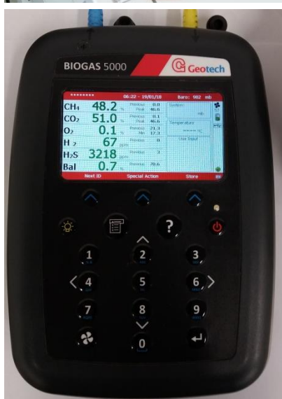
Obrázek 2 Aparatura pro testy produkce bioplynu, analyzátoy bioplynu, TS, TGA a CHNSO
