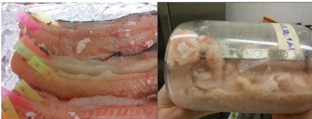
Obr. 3. Vzorkování PBT látek v tkáni ryb pomocí rozdělovacího pasivního vzorkování do tenkých plátů silikonové pryže. V statické metodě (vlevo) jsou platy vloženy do řezu ve filetu a inkubovány cca. 2 dni. V dynamické metodě je vzorkování PBT látek urychleno vzájemným promícháváním silikonové pryže a kousků rybí tkáně.
