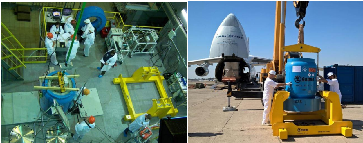
Obrázek č. 3: Příprava nakládky na sále reaktoru v Bělorusku (vlevo) a překládka naloženého kontejneru do letadla na letišti v Uzbekistánu (vpravo)
