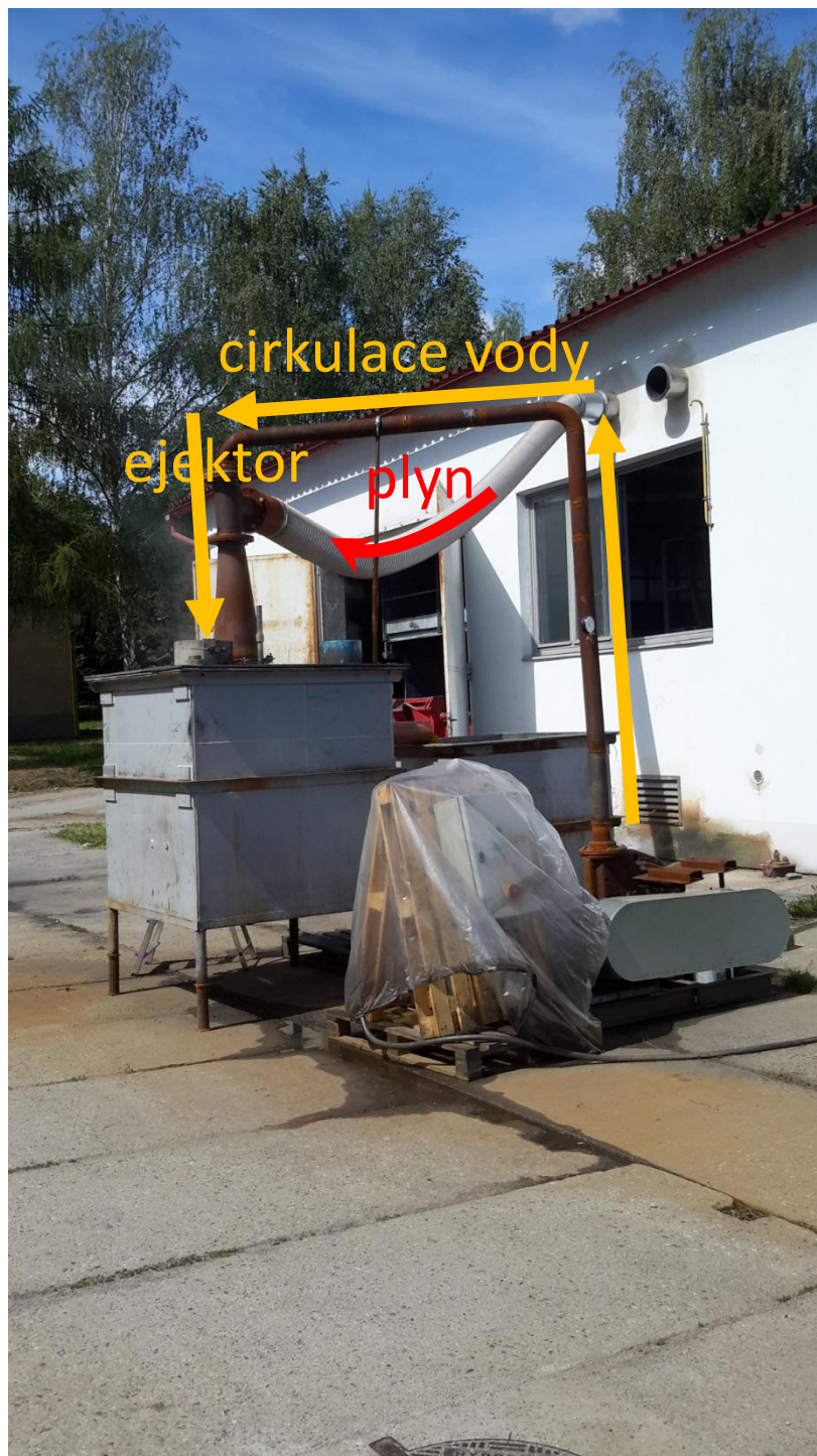
Obrázek 8: provozní zařízení s ejektorem pro záchyt dýmu pro zkušební provoz.
