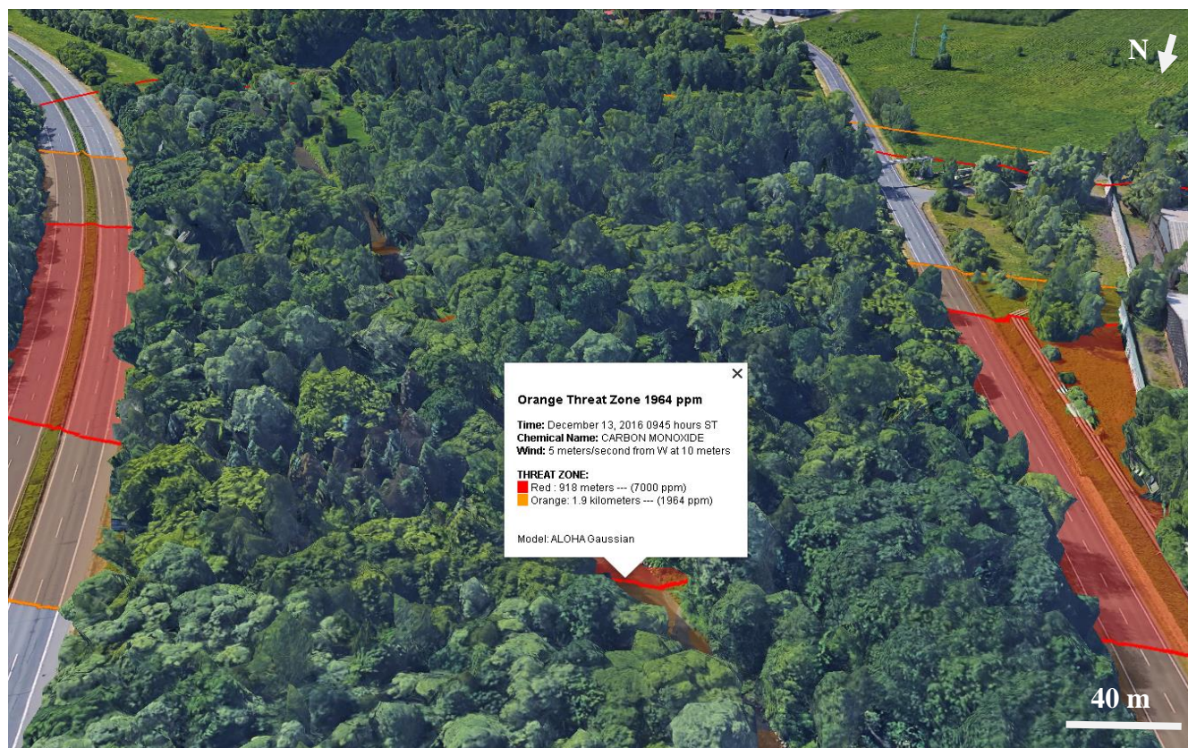
Obr. 11: Znárodnění výsledků modelu a hlavní silnice a pozemní komunikace vně areálu podniku.
