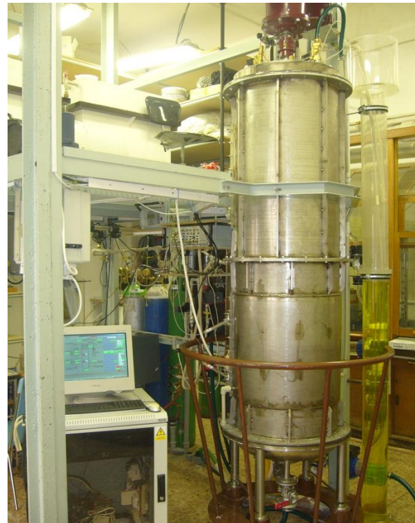
POLOPROVOZNÍ MĚŘÍTKO D = 0,6m V L = 510 L
