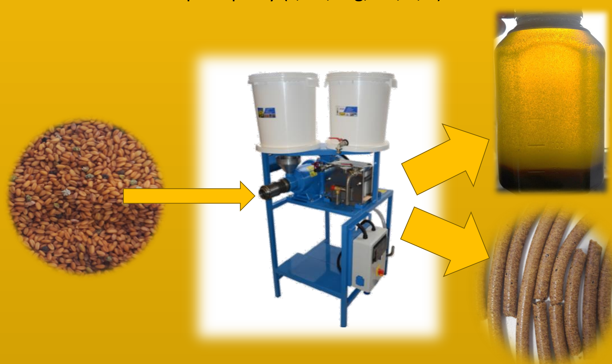
Obr. 2: Schéma lisovania semien Camelina sativa na lise FARMER 10 1FM, ktorého výsledkom boli valcovité výlisky a ľaničnikový olej so sedimentom
