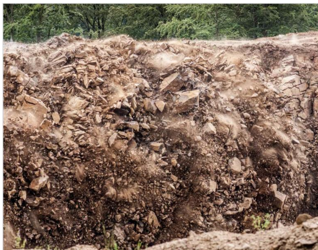
Obr. 3: Práce trhavin ve skalním masivu. Dobře je pozorovatelná fragmentace horniny směrem od lomové stěny. (Zdroj: katalog trhavin Explosia Semtín)
