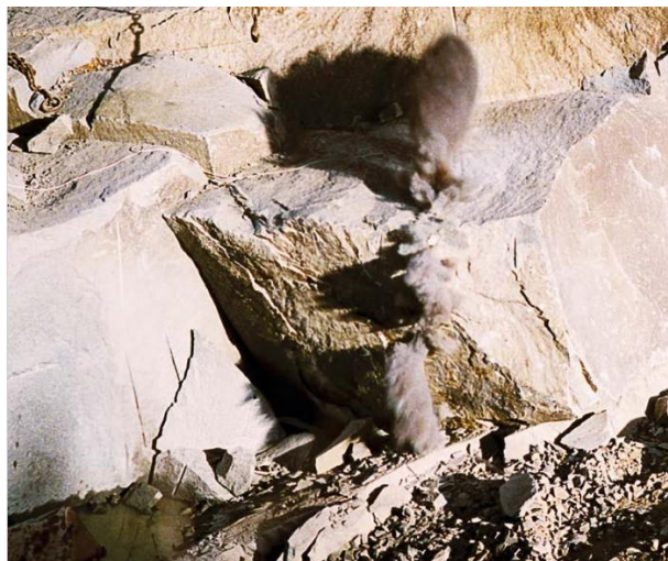
Obr. 4: Ušlechtilá kamenická výroba. Vylomení bloku horniny pomocí střelného prachu. Je vidět vymetení ucpávky. (Zdroj: katalog trhavin Explosia Semtín)
