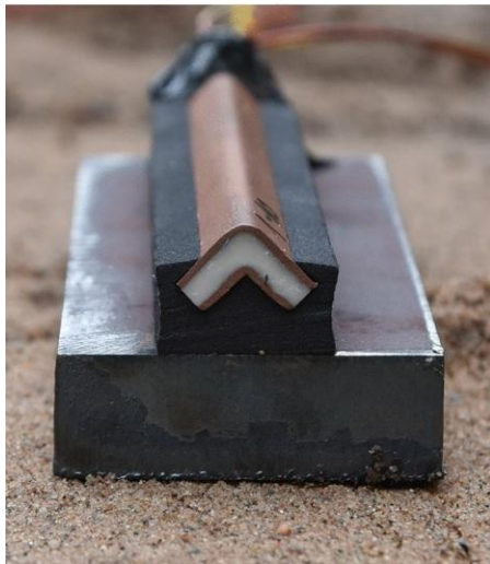
Obr. 9: Táhlá kumulativní nálož. Nálož je plastická, lze ji tvarovat a spodní samolepící stranou přilepit na předmět. (Zdroj: katalog trhavin Explosia Semtín).
