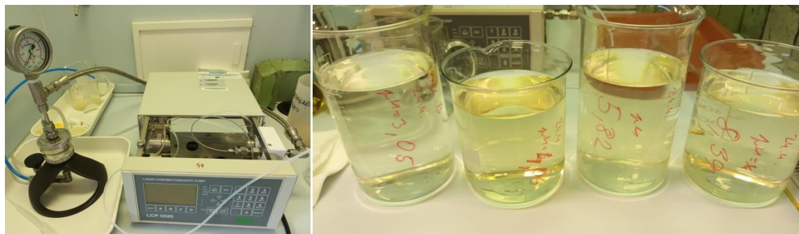
Obr. 3 Filtrační zařízení a připravené roztoky
