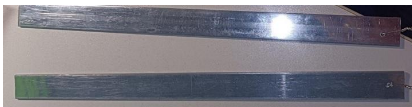
Obr.4 Ukázka kovových elektrod vhodných pro elektroseparatori rtuti
