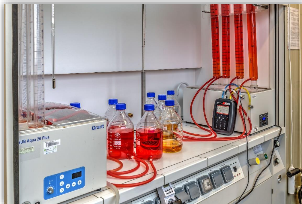
Obrázek 2 Aparatura pro BMP test a analyzátor bioplynu
