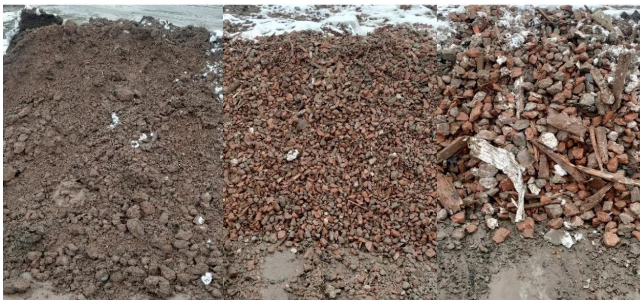
Obr. 3: Recyklát: frakce 0/8 mm (vlevo), frakce 8/32 mm (uprostřed), frakce 32/63 mm (vpravo).
