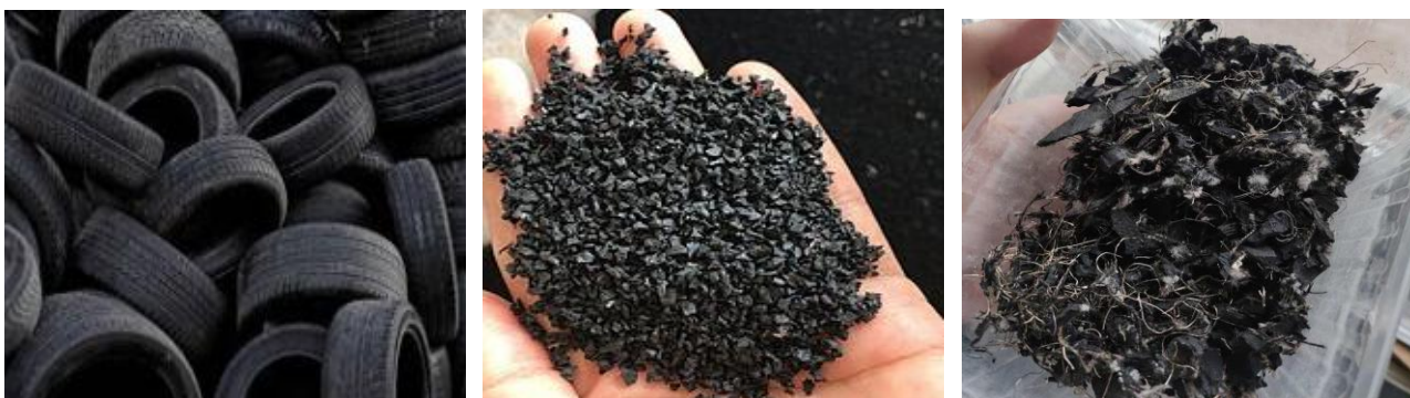
Obr. 2 Použité pneumatiky vhodné na recykláciu, gumový granulát, drátky z pneumatík [5]
