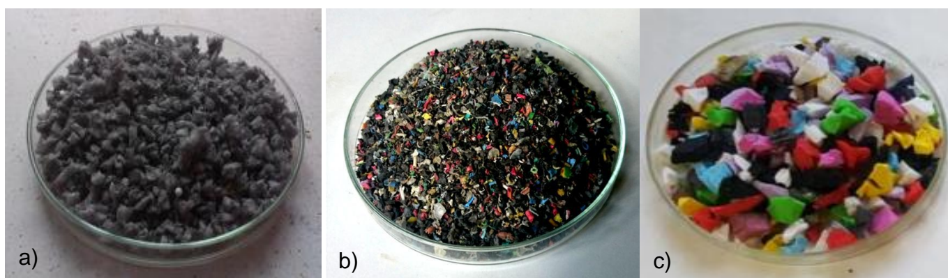
Obr. 1 a) PP, frakcia 4/8 mm b) recyklát z káblov frakcia 0/4 mm c) EVA, frakcia 4/8 mm
