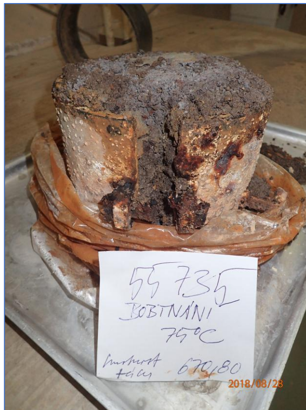
Obrázek 6 Pohled na vzorek zhuťněný 100% energií Proctor standard při teplotě 75°C po 352 dnech (hypermarket TESCO) a destrukci CBR moždíře
