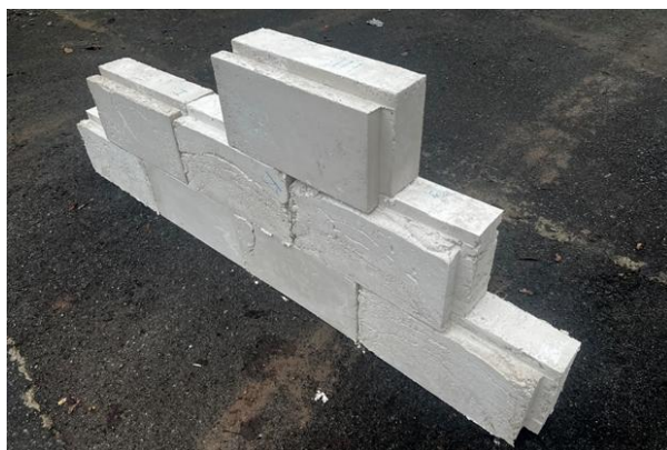
Obr. 5: Poloprovozně vyrobené a sestavené sádrové bloky.
