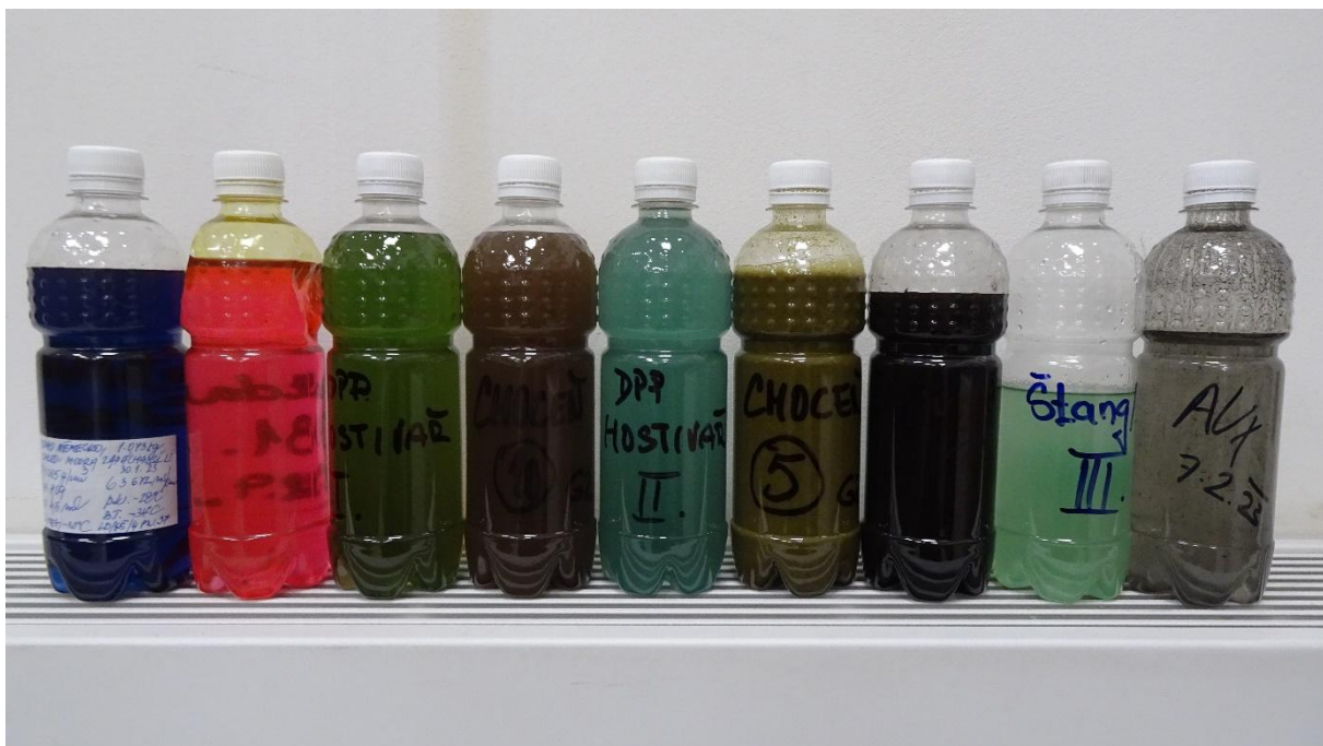
Obr. 2: Příklad vzhledu tekutých stavebních odpadů z náplní teplosměnných okruhů budov.
