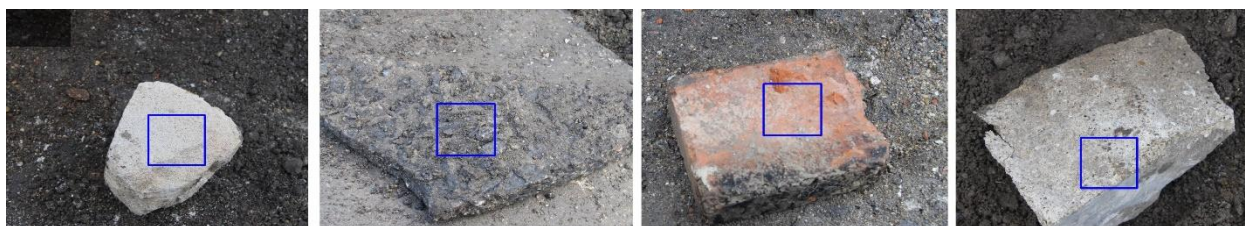
Obrázek 2: reprezentativní digitální snímky analyzovaných fragmentů SDO s vyznačenou oblastí zájmu, zleva: pórobeton, asfalt, cihla a beton.
